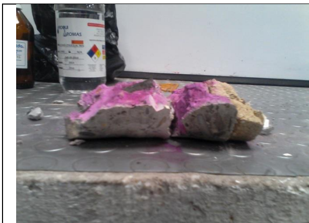
Foto 21 Medición del PH del concreto con fenolftaleína
