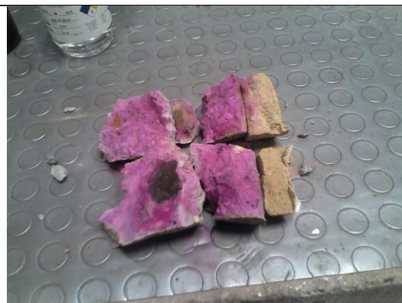
Foto 22 Medición del PH del concreto con fenolftaleína
