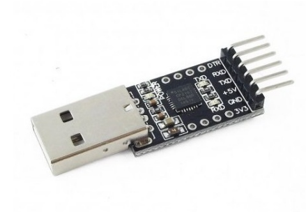
Figura 5.2.5: Módulo CP2102 para transmisión de datos Fuente: (JA-Bots, 2024)
