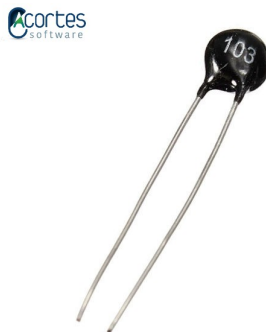
Figura 5.2.3: Termistor NTC de 10 k \Omega Fuente: (Acortes Software, 2022)
