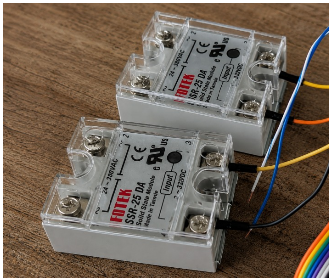
Figura 5.4.4: Relés de estado solido conectados
