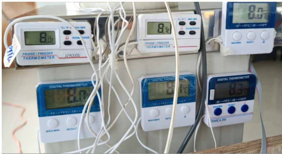
Figura 6.4.1: Termómetros ubicados dentro del baño termostático para evaluar temperatura.
