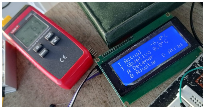
Figura 5.4.8: A la izquierda el termómetro UT320D, y a la izquierda la LCD mostrando el valor de temperatura
