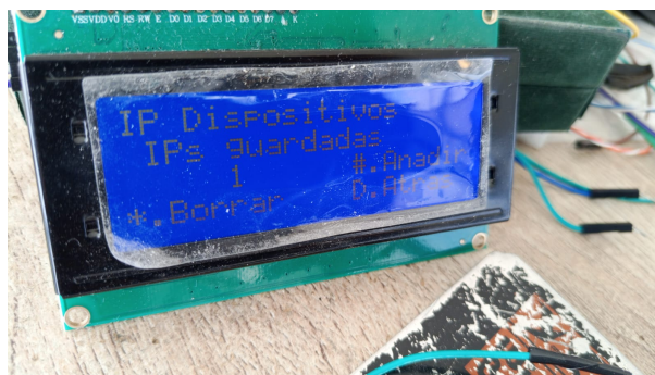
Figura 5.7.4: Pantalla LCD que muestra la cantidad de IPs almacenadas en la memoria de la ESP.
