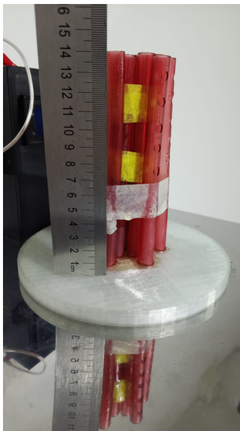
Figura 5.6.2: Longitud de tubo impreso en 3D, mostrada con una regla.
