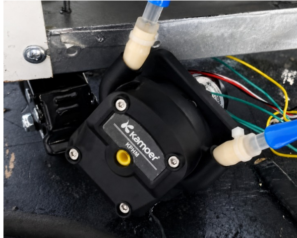
Figura 5.4.5: Bomba peristáltica conectada a mangueras
