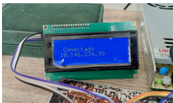
Figura 5.7.5: Pantalla LCD que muestra la conexión satisfactoria con el cliente vía Wi-Fi.
