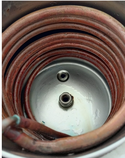
Figura 5.4.10: Serpentín de cobre alrededor de la pared interna del recipiente, permite contacto directo con el líquido.
