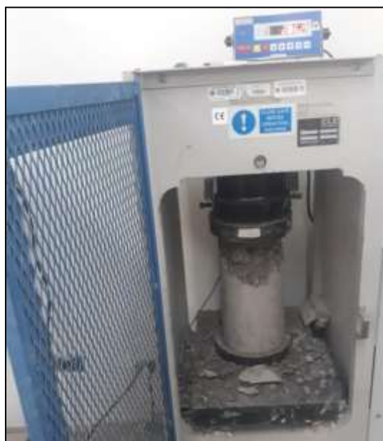
Figura 10.11. Ensayo destructivo concreto convencional.
