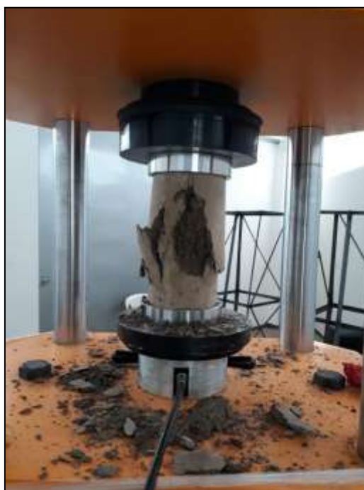
Figura 10.12. Ensayo destructivo de cuesco y concreto de RCD Fuente: Autores 2019.
