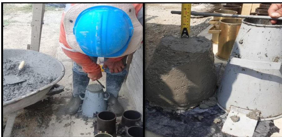
Figura 5146. Ensayo de asentamiento.
