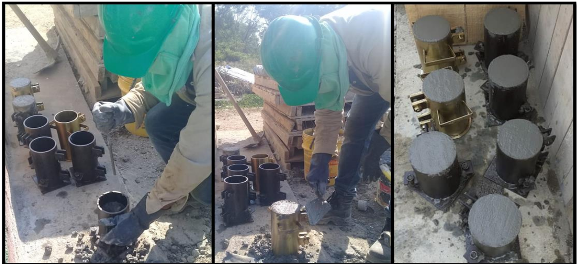
Figura 52. Toma de muestras, cilindros de concreto.
