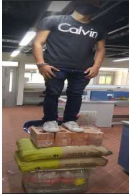
Ilustración 60. resistencia de 207 Kg del casetón 11 Fuente: Propia
