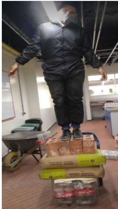
Ilustración 61. Resistencia de 235 kg del casetón (unión 1,2,3,4) Fuente: Propia
