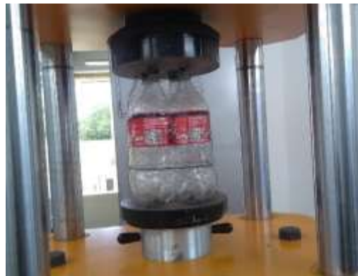
Ilustración 62. Casetón 2 x 2 envases de Coca cola 2.5 L Fuente: Propia
