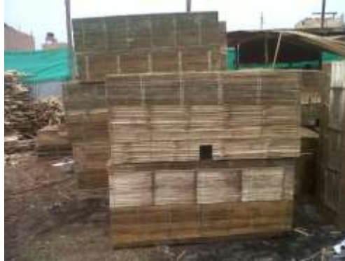
Ilustración 2. Casetón guadua para aligeramiento de losa Fuente: ENCOFRADOS, Román botero
