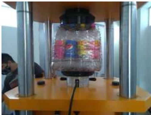
Ilustración 63. Casetón 4 X 4 envases de Postobón de 2 L Fuente: Propia
