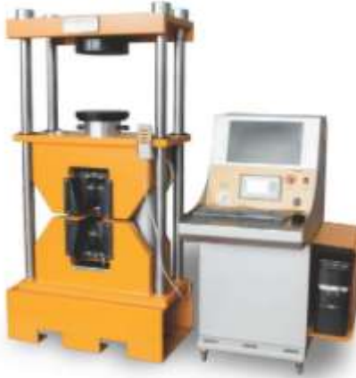
Ilustración 8. Máquina Automática Para Compresión. Fuente: ALFA test
