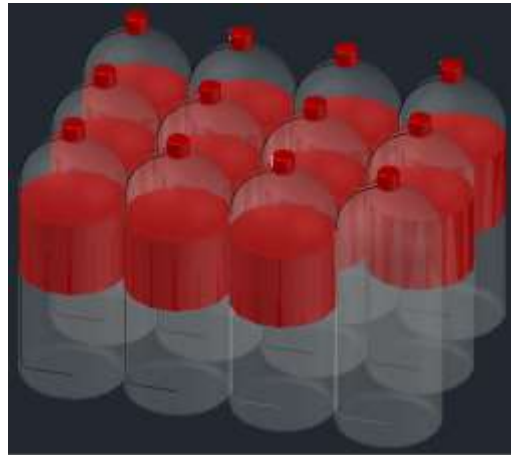
Ilustración 47. Modelo 3D del casetón Fuente: propia
