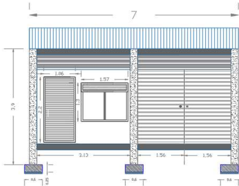
Ilustración 65. Facha bodega de un piso Fuente: Propia
