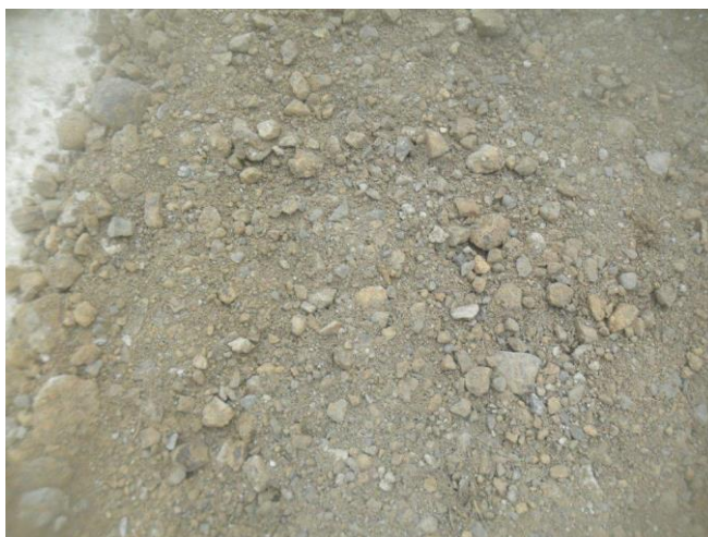
Figura 18. Granulometría material de relleno sub-rasante. Fuente: Elaboración propia
