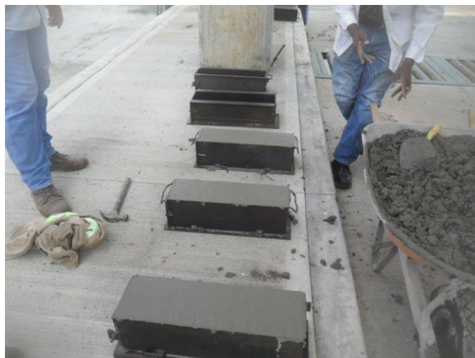
Figura 31. Toma de muestras, ensayo módulo de rotura. Fuente: Elaboración propia
