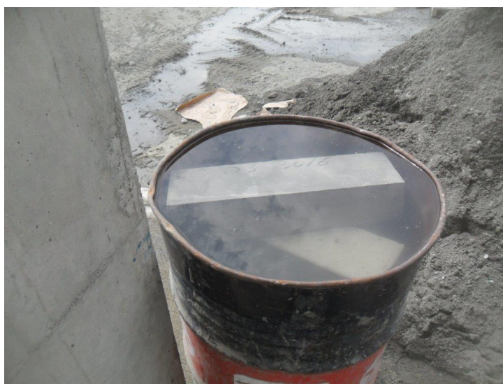
Figura 32. Curado de viguetas para ensayo. Fuente: Elaboración propia
