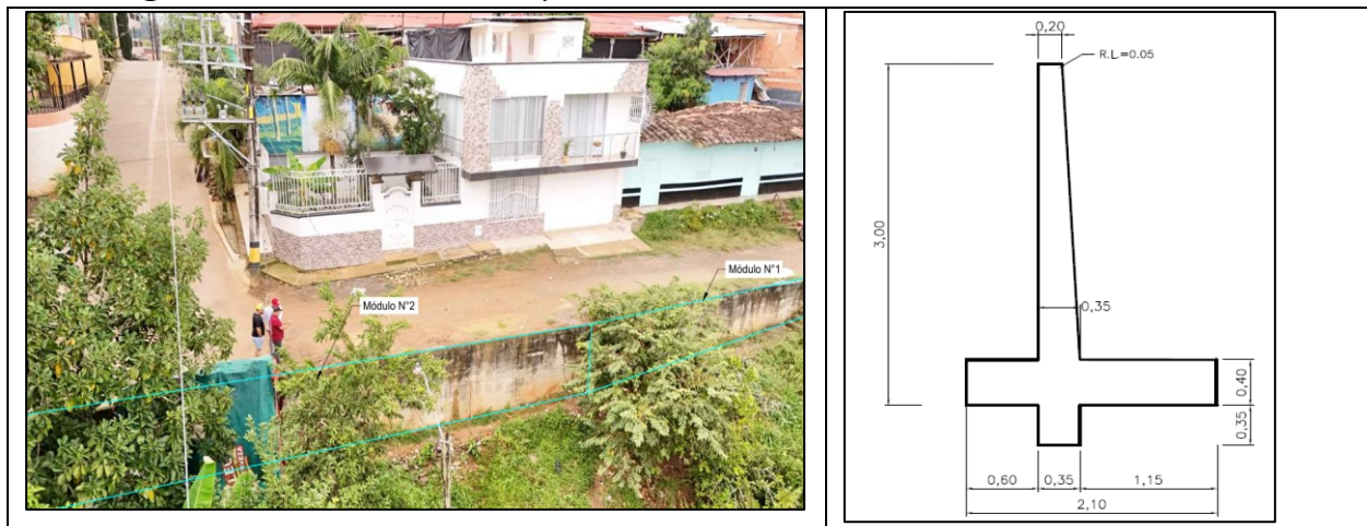
Figura 1. Muro de contención y dimensionado
