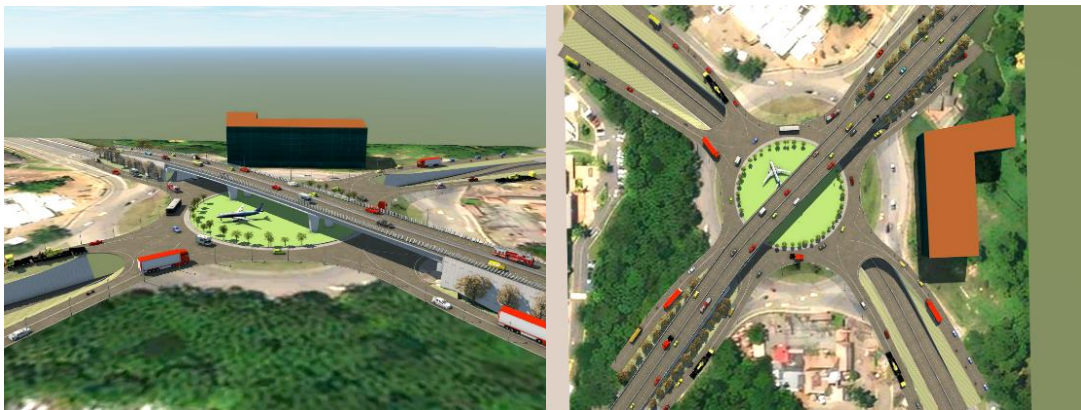
Figura 14 Modelo de paso a desnivel
