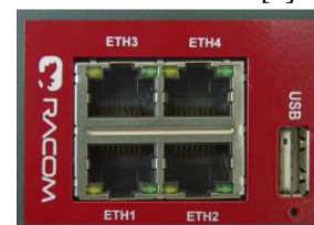
Figura 57. Conexiones RJ45 red LAN [5]
