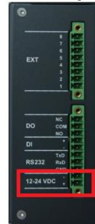
Figura 56. Alimentación DC del dispositivo [5]
