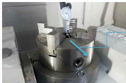
Figura 38. Verificación Paralelismo plano Mesa XY y Copa
