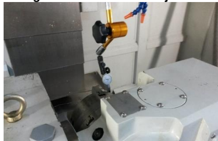
Figura 40. Verificación Eje B-90
