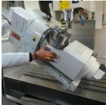
Figura 34. Acercamiento Montaje de Basculante
