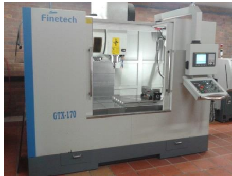
Figura 1. Configuración típica de un centro de mecanizado vertical de 3 ejes
