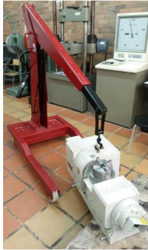
Figura 33. Izamiento del Basculante
