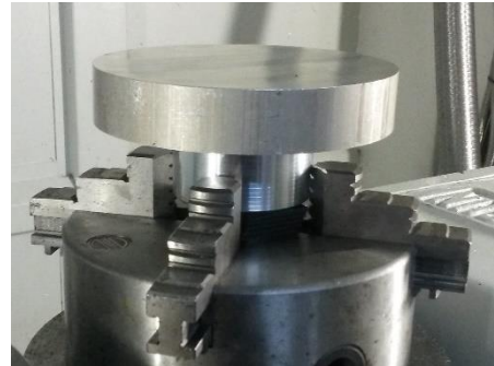
Figura 42. Montaje Materias Primas en Mordazas
