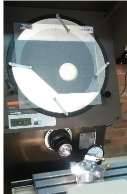
Figura 48. Proceso de Medición en Proyector de Perfiles
