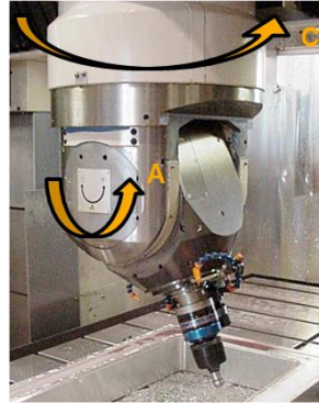
Figura 6. Grados de libertad rotativos, configuración herramienta/herramienta
