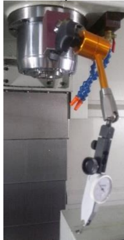
Figura 37. Ensamble Comparador de Caratula-Brazo
