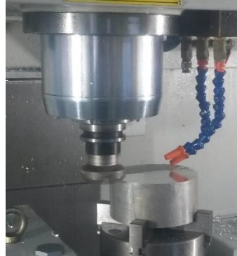
Figura 44. Desbaste Para Garantizar Cara Plana
