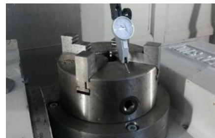
Figura 38. Verificación Paralelismo plano Mesa XY y Copa
