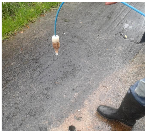
Ilustración 7 - Adición del cloro por goteo
