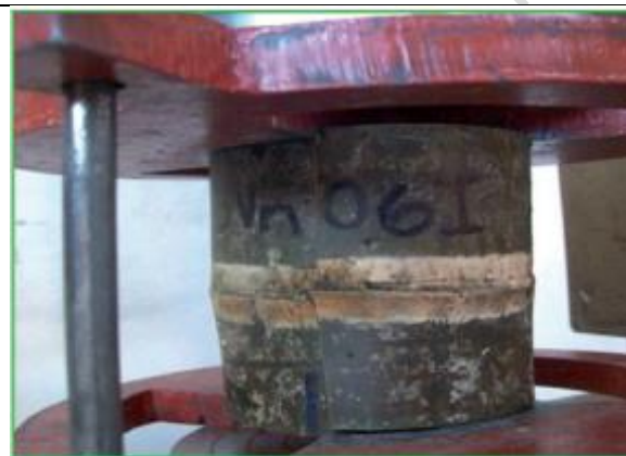
Fotografía 1: Probeta de guadua angustifolia kunth ensayo a compresión axial. Fuente: Luna P. Lozano J. Takeuchi C. A.A. Guías de diseño para estructuras de Guadua Angustifolia Kunth. Guadua y su industria. Pg. 129
