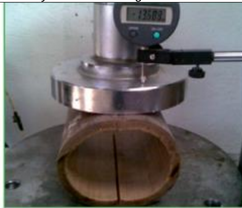
Fotografía 2: Probeta de guadua angustifolia kunth ensayo a compresión perpendicular a la fibra. Fuente: Fuente: Luna P. Lozano J. Takeuchi C. A.A. Guías de diseño para estructuras de Guadua Angustifolia Kunth. Guadua y su industria. Pg. 129
