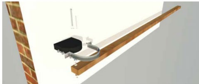
Figura 7. Detalle desacoplador acústico
