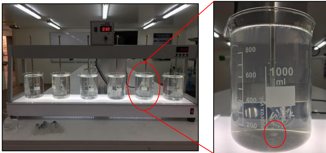
Fotografía 39. Ensayo de jarras. Dosis optima jarra N° 5 (Tatiana Zapata, 2019).
