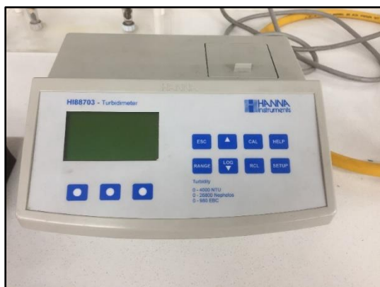
Fotografía 34. Equipo HANNA Instruments para medir turbiedad con sus respectivas muestras patrón (Tatiana Zapata, 2019).
