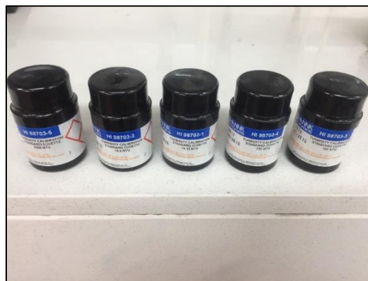
Fotografía 34. Equipo HANNA Instruments para medir turbiedad con sus respectivas muestras patrón (Tatiana Zapata, 2019).
