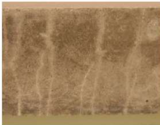
Ilustración 4. Residuo blanco que llena las grietas después del curado claramente observado en la superficie de la muestra (Qian, y otros, 2009)
