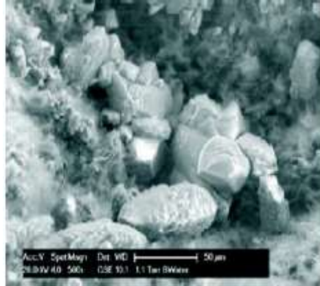
Ilustración 9. Foto de un microscopio electrónico de barrido ambiental de precipitación de calcio con amplificación de 20000 veces.
