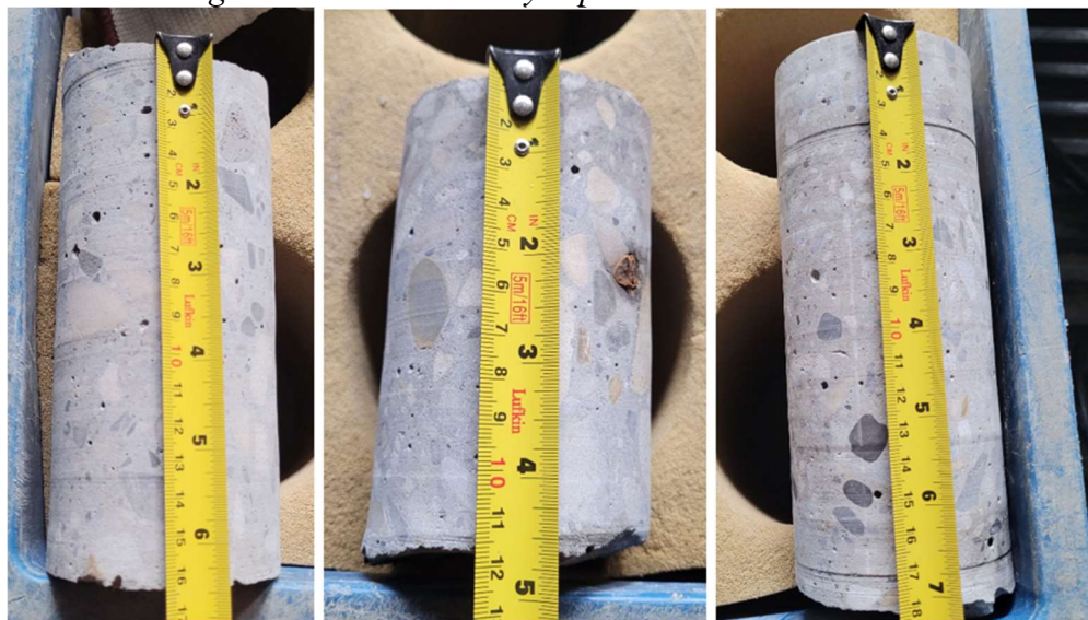
Figura 35. Dimensiones y aspecto de las extracciones
