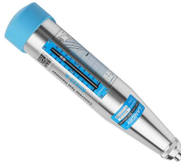
Figura 25. Equipo utilizado, esclerómetro
