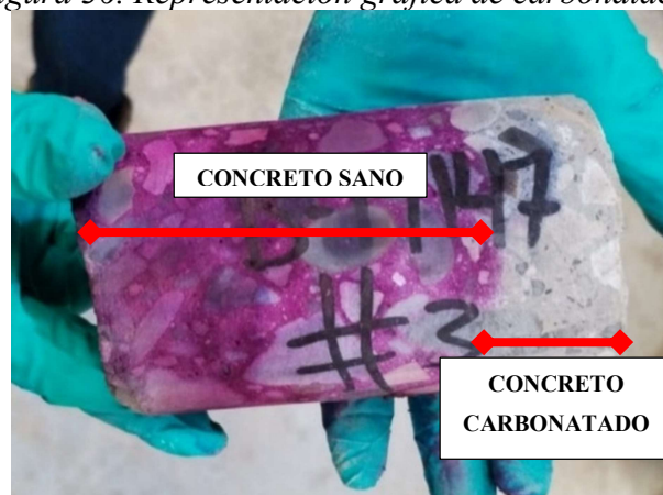
Figura 36. Representación gráfica de carbonatación
