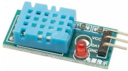
Figura 23. Sensor de Temperatura y Humedad DHT11 Fuente: Guamán, P. F. J., & Mejía, J. B. C. (2020) [22].
