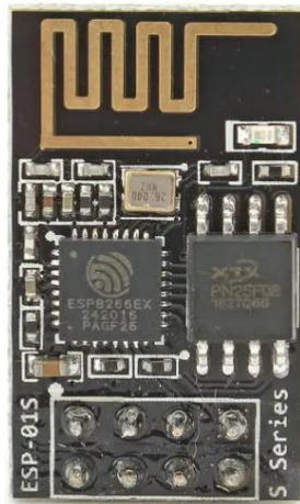
Figura 21. Módulo de comunicación Wi-Fi ESP8266. Fuente: Guamán, P. F. J., & Mejía, J. B. C. (2020) [22].
