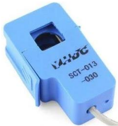
Figura 20. Sensor SCT-013-030 medición de corriente en su intensidad. Fuente: Guamán, P. F. J., & Mejía, J. B. C. (2020) [23].
