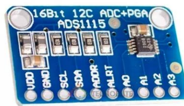
Figura 22. Módulo de convertidor analógico a digital ADS1115. Fuente: Guamán, P. F. J., & Mejía, J. B. C. (2020) [22].
