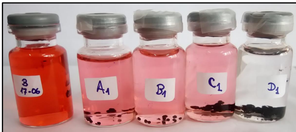
Figura 1. Remoción de una solución de colorante Rojo 40 de 50 mg/L utilizando A1) 10 mg, B1) 20 mg, C1) 40 mg y D1) 80 mg de perlas de quitosano magnetizadas.
