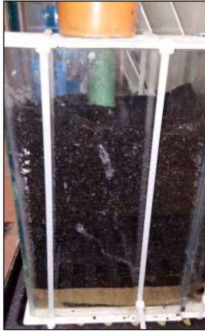
Ilustración 35 Filtro de antracita y arena sílice.
