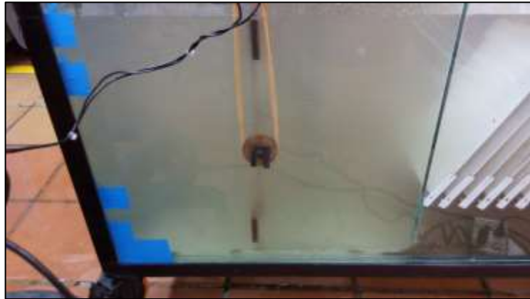
Ilustración 33 Paletas del floculador.
