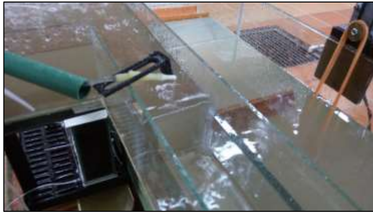
Ilustración 31 Canal de mezcla rápida.
