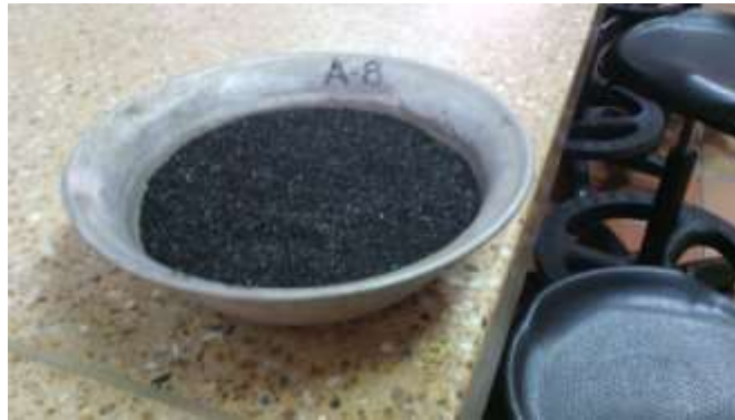
Ilustración 27 Muestra de antracita.
