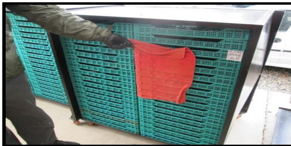
Figura 23. Fotografía frontal del sistema de extracción de humedad excesiva en el arándano después de cosecha, finca El Lago de la empresa Proplantas S.A., Chía, Cundinamarca.
