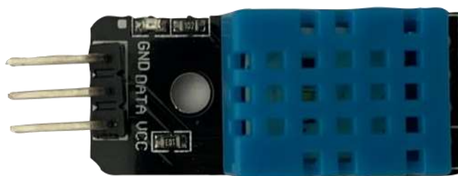
Ilustración 16. DTH11 sensor de temperatura y humedad [Autoría Propia].
