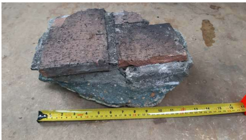
Figura 13. Detalle estructura de cubierta bóvedas. Fuente propia.
