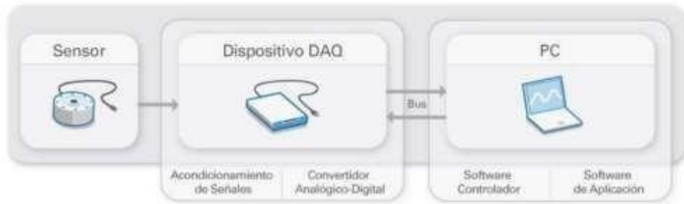
Imagen 2. Funcionamiento de un sistema de adquisición de datos [8].
