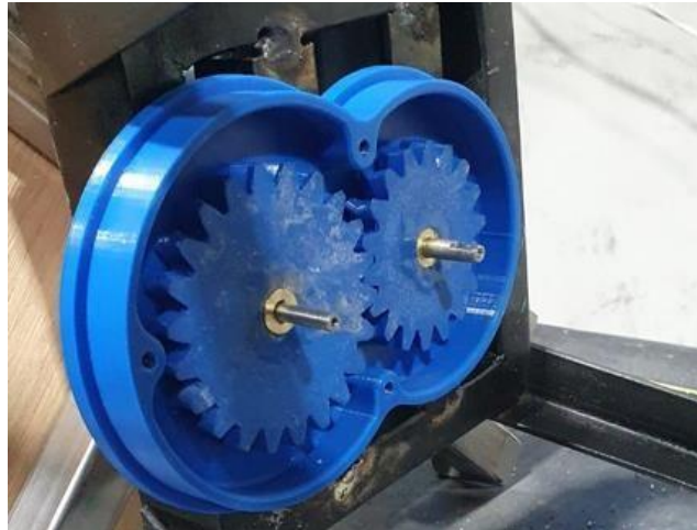
Imagen 46. Tren de engranajes fabricado para el prototipo del aerogenerador.
