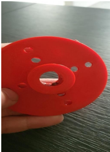
Imagen 32. Buje para soportar los modelos Savonius y Darreius.
