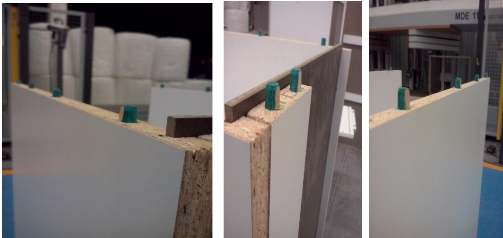
Figura 12. Desgaste intencional para la prueba de módulos
