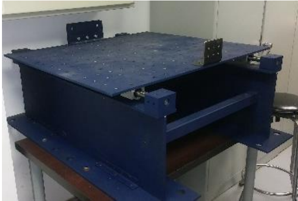
Fotografía 12. Mesa Vibradora - vista lateral.
