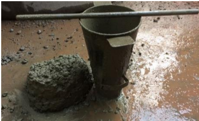
Fotografía 3. Prueba de Slump a la mezcla de concreto.
