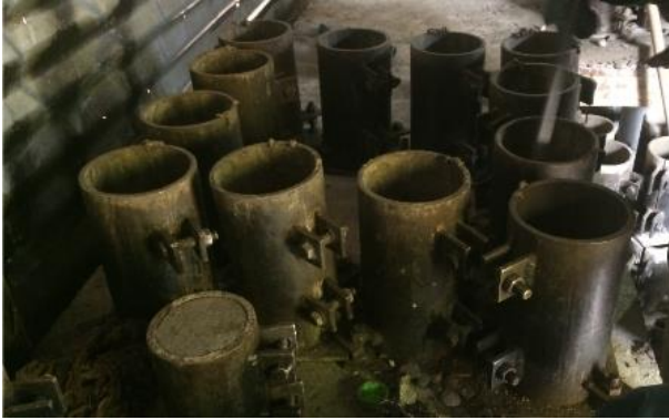
Fotografía 6. Cilindros de concreto para los ensayos.
