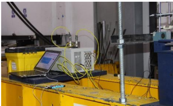
Fotografía 18. Fotografía 18. Equipo de Control de la Mesa Vibradora.
