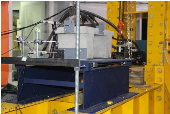
Fotografía 21. Montaje de los modelos en la Mesa Vibradora.
