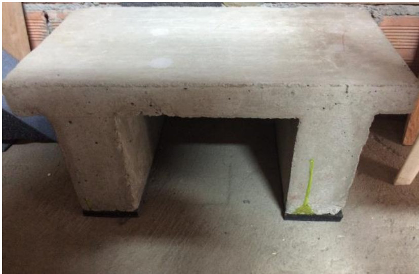
Fotografía 9. Placas instaladas la parte inferior de las vigas del Modelo 2.
