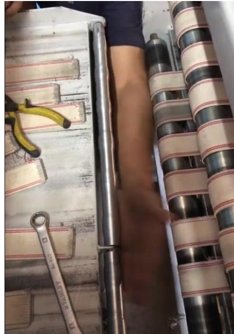
Figura 27. Fotografía cambio y lubricación de rodamientos de ejes.
