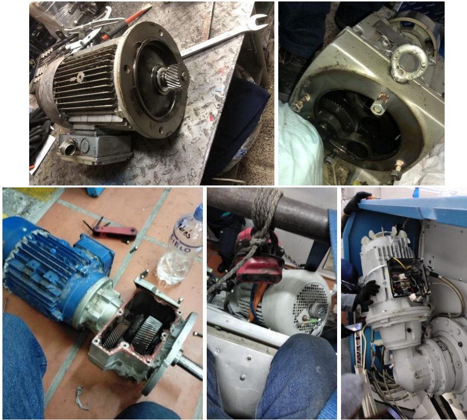
Figura 23. Fotografías desmontaje, revisión cajas reductoras y motores varios.
