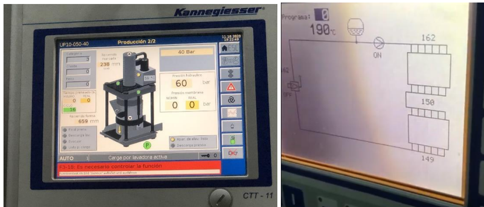
Figura 22. Fotografías pruebas de funcionamiento de prensa y sistema de bombeo de aceite de calandra Kannegiesser.
