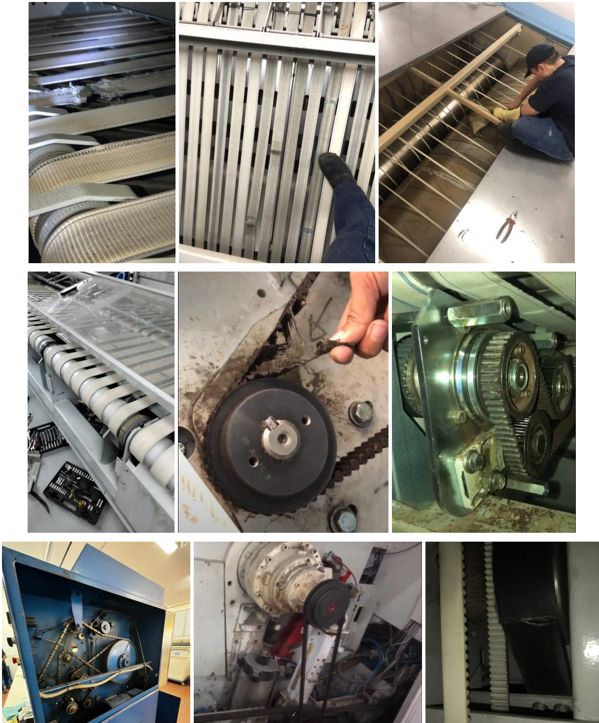
Figura 25. Fotografías cambio de bandas, correas y cintas guías en calandras y sistemas de transmisión.
