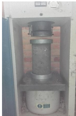
Figura 21. Ensayo de resistencia a compresión
