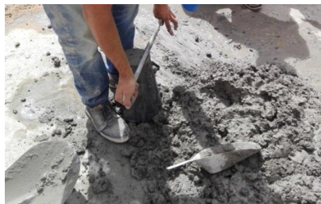
Figura 19. Ensayo de asentamiento
