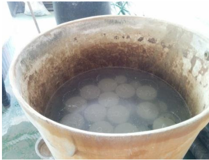
Figura 18. Curado de los especímenes de concreto
