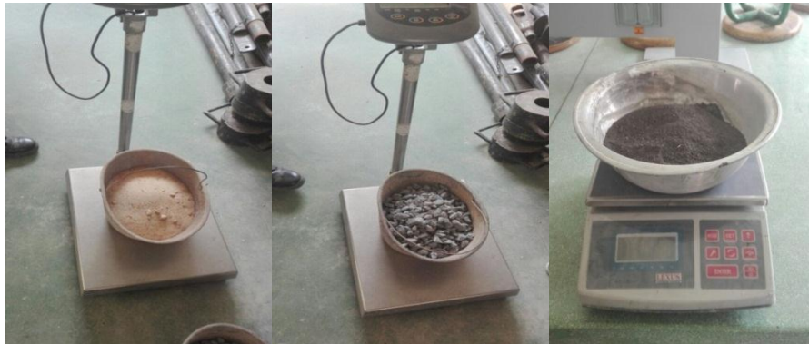
Figura 14. Pesaje de materias primas para la elaboración de los especímenes de concreto
