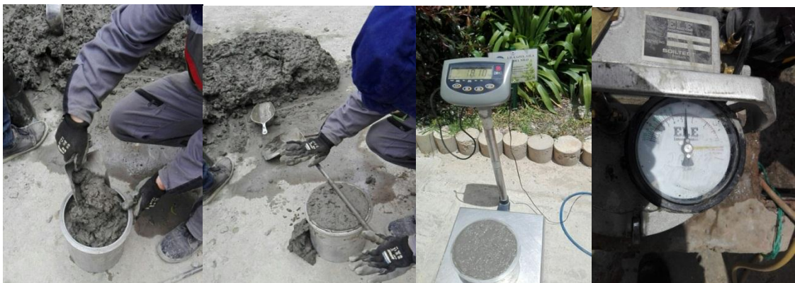
Figura 25. Ensayo de contenido de aire
