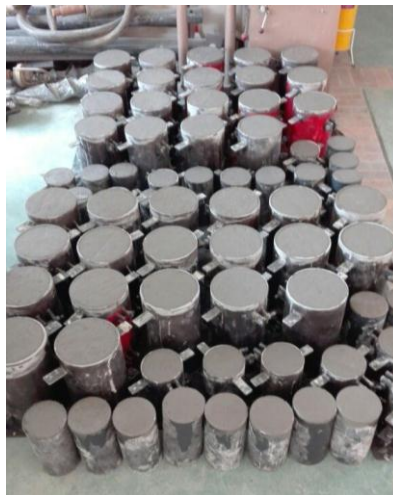
Figura 17. Secado de los especímenes de concreto con inclusión de Biosólido
