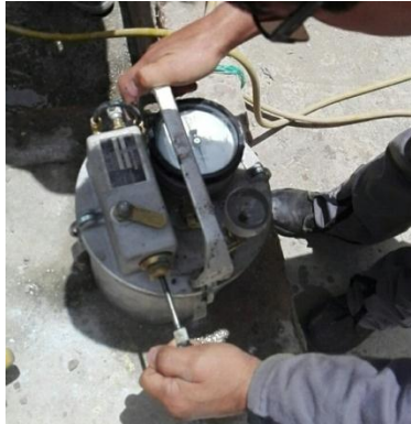
Figura 20. Ensayo de contenido de aire
