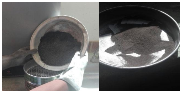
Figura 23. Granulometría del biosólido
