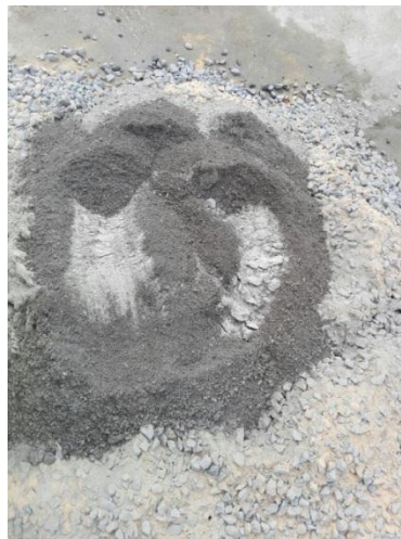
Figura 15. Mezcla de Arena, Grava, Cemento y Biosólido
