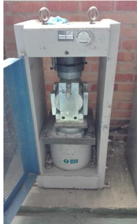
Figura 22. Ensayo de resistencia a tensión indirecta.
