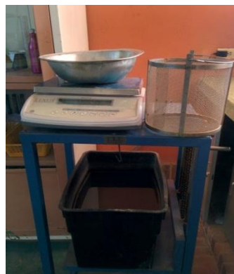
Figura 7. Prueba de absorción de agua de la grava
