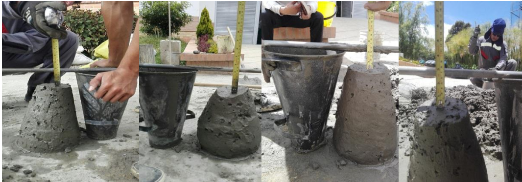
Figura 26. Ensayo de asentamiento
