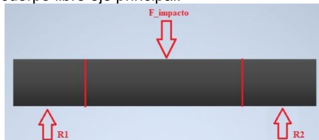
Figura 25. Diagrama de cuerpo libre eje principal.
