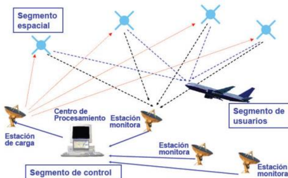
Figura 6. Funcionamiento de un GNSS. Fuente. [40]
