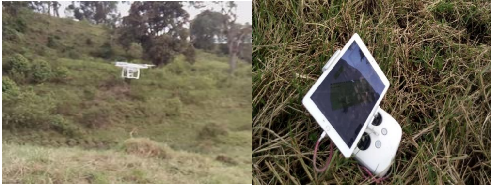
Figura 33. Fotos toma de datos topográficos con UAV en campo. Fuente. Autores
