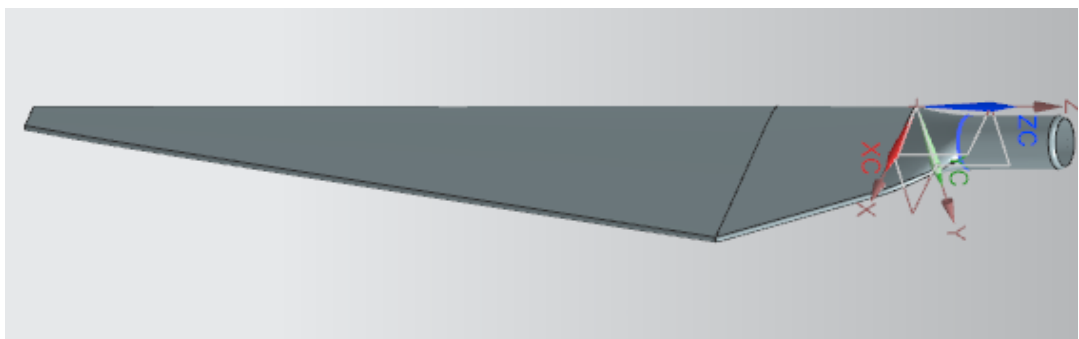
Figura 4. Vista en isométrico del álabe con sus filos vivos redondeados.
