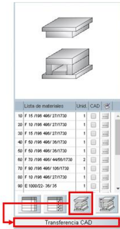
Figura 47. Transferencia CAD de las piezas.
