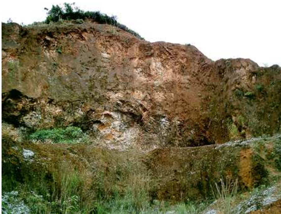
Fotografía 2. Desgarre superficial debido a movimientos en masa sobre la parte baja de la vertiente.
