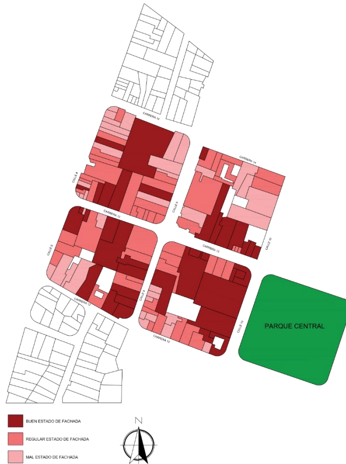
Figura 71. Estado de las fachadas del Sector del Centro
