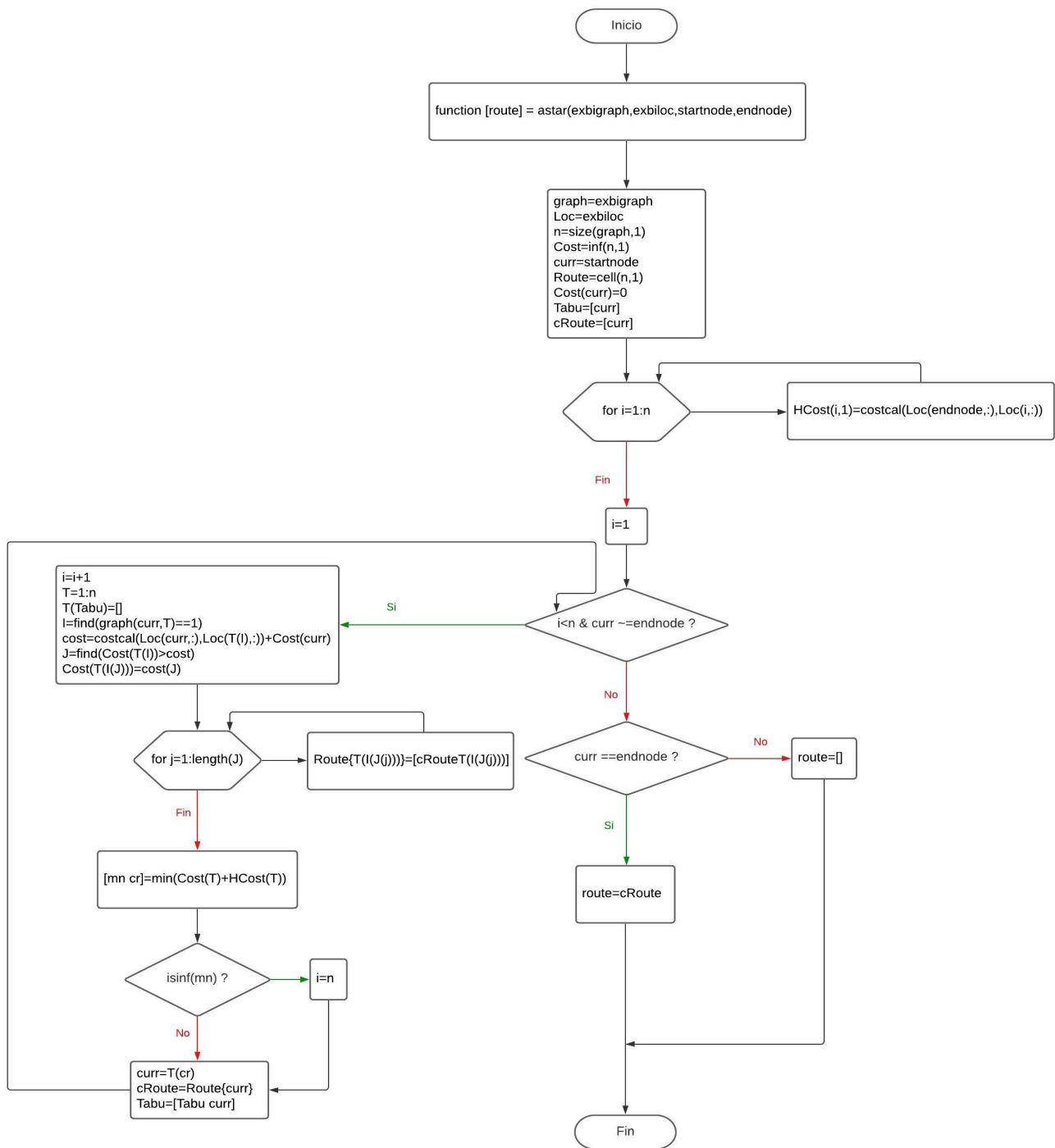
FIGURA 11: Diagrama de flujo de algoritmo de planeación de trayectorias Astra / Fuente: Autor
