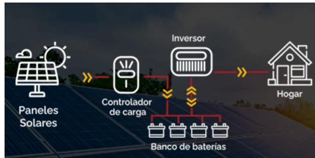
Figura 1: Sistema fotovoltaico aislado. Tomado de [ https://solarama.mx/blog/sistema-solar-aislado/ ]
