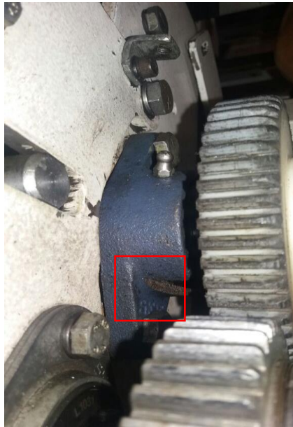
Ilustración 39. Rotura de chumacera
