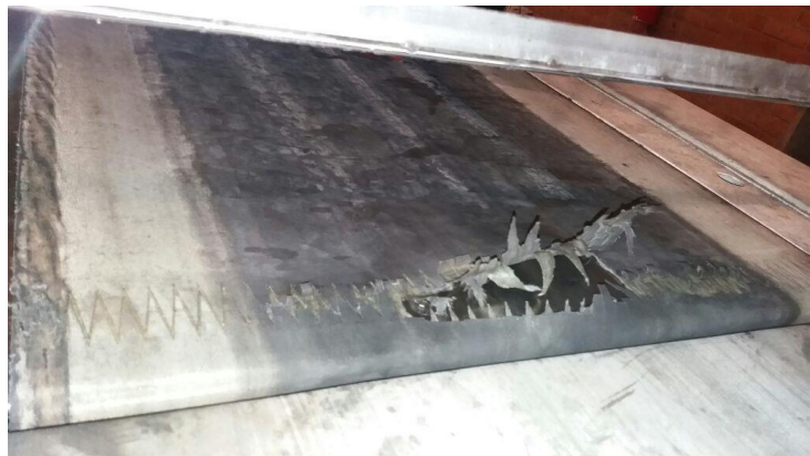
Ilustración 40. Rotura de banda transportadora
