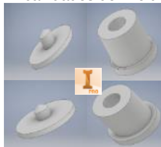
Figura 26. Modelado CAD cavidades del molde de inyección
