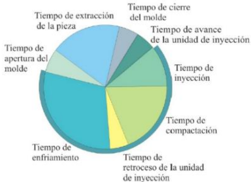
Figura 3. Tiempos en el ciclo de inyección
