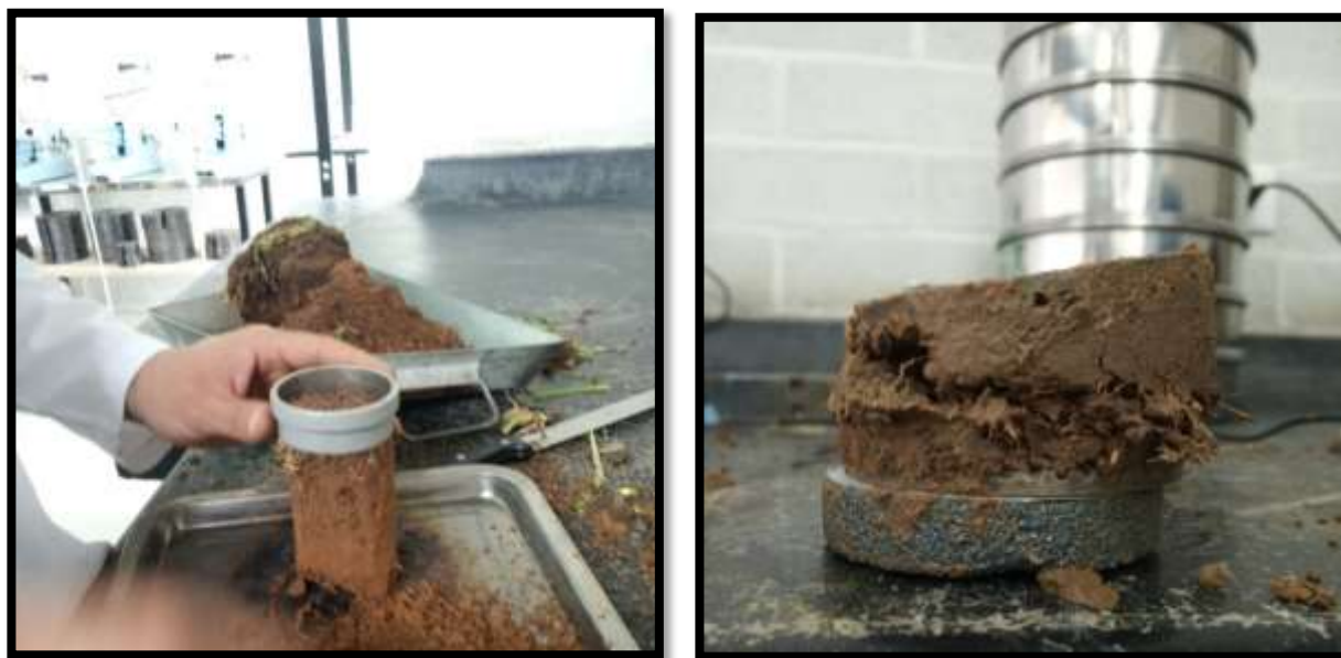
FIGURA 7. PREPARACIÓN DE MUESTRA Y RESULTADO DEL CORTE DIRECTO.
