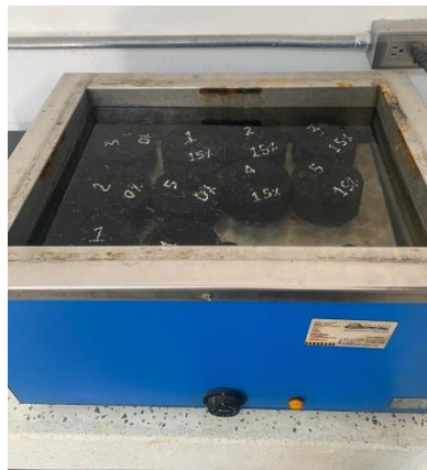
Figura 36. Inmersión de briquetas a baño María.
