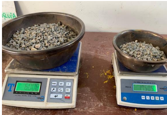
Figura 21. Peso muestras para análisis granulométrico y determinación de humedad.
