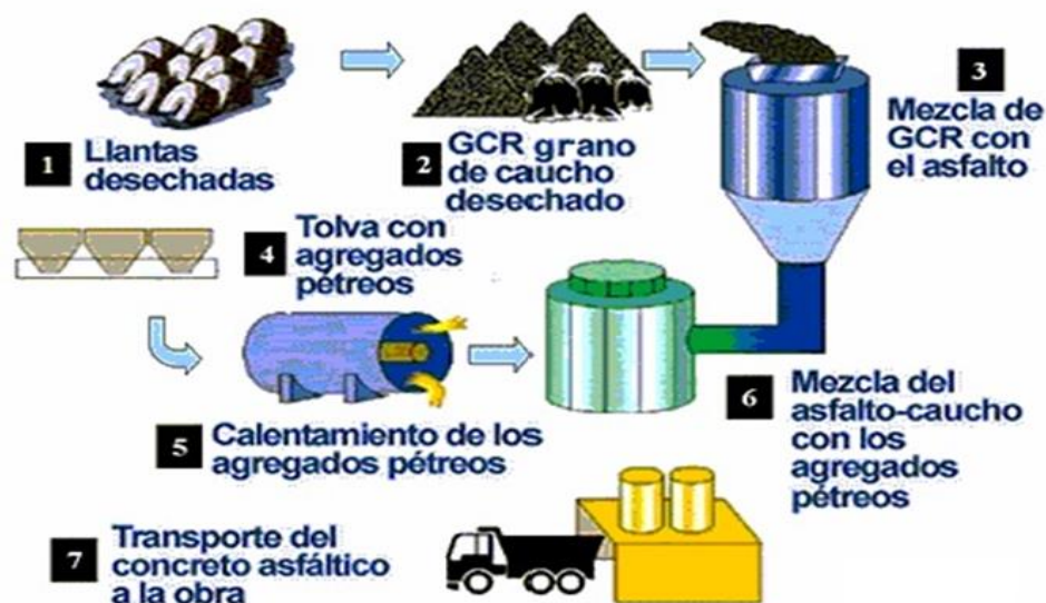
Figura 5. Proceso de modificación por vía húmeda
