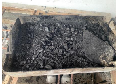
Figura 28. Mezcla asfáltica lista para elaboración de briquetas
