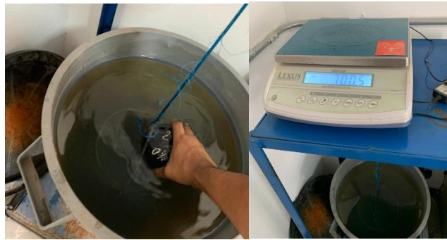
Figura 35. Obtención peso en inmersión de briquetas por medio de péndulo casero.
