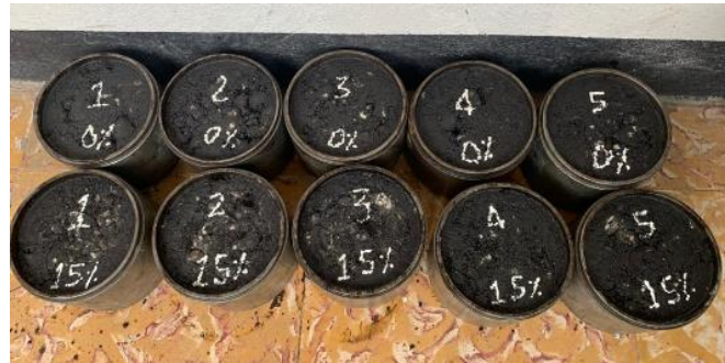
Figura 32. Enfriamiento y numeración de briquetas.
