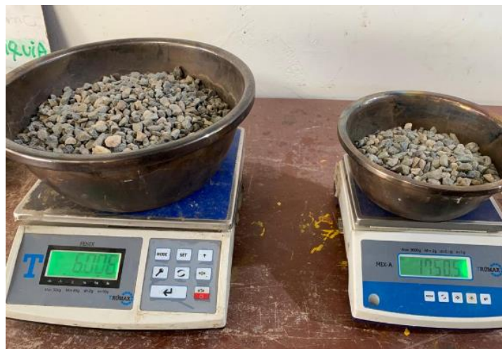
Figura 16. Peso muestras para análisis granulométrico y determinación de humedad.
