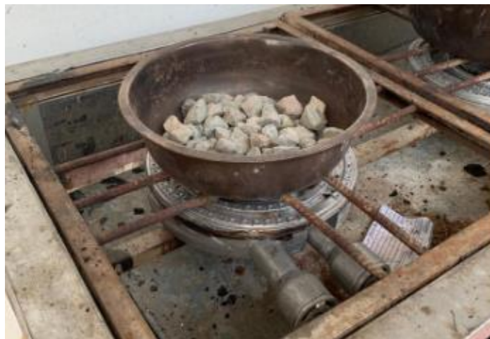
Figura 22. Secado en estufa del material para determinación de humedad.
