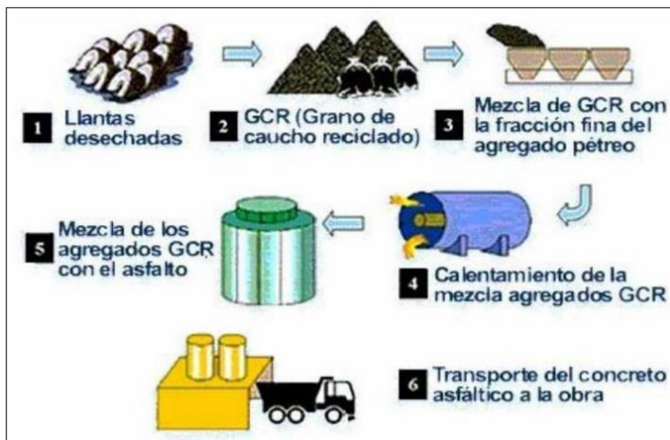
Figura 4. Proceso de modificación por vía seca.
