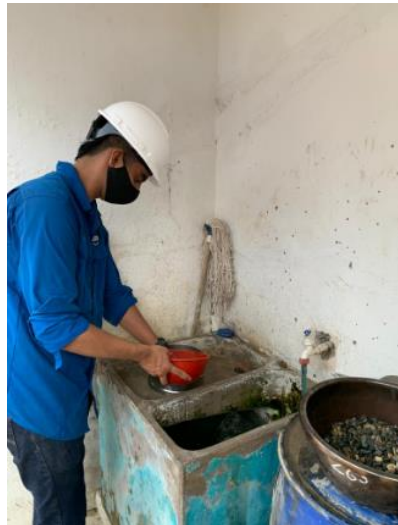
Figura 18. Lavado de materiales pasando por tamiz N°200
