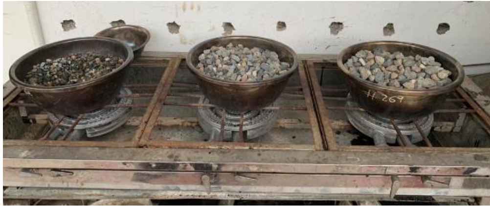
Figura 19. Secado en estufa del material para análisis granulométrico.
