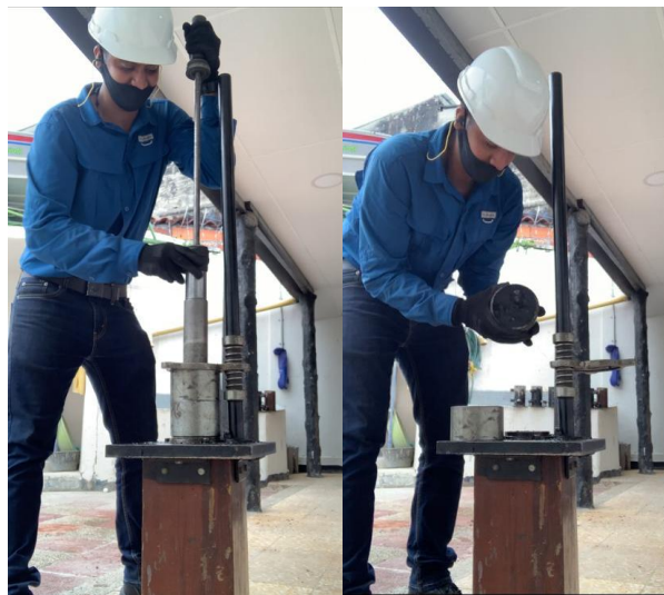
Figura 31. Compactación aplicando 75 golpes por ambas caras de la briqueta con el martillo de compactación del aparato de Marshall.
