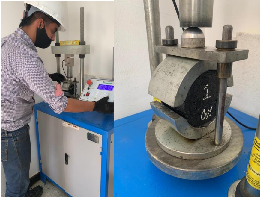
Figura 37. Determinación de estabilidad y flujo de las briquetas por medio de la máquina de Marshall.
