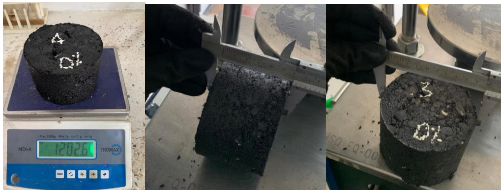
Figura 34. Peso al aire, medición de altura y espesor de briquetas.
