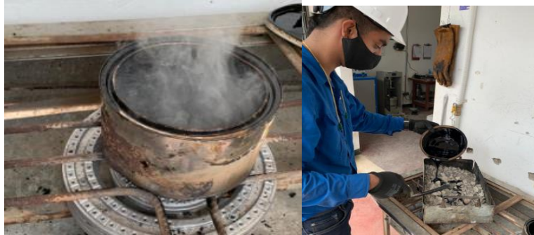
Figura 26. Adicion del cemento asfaltico a la mezcla.
