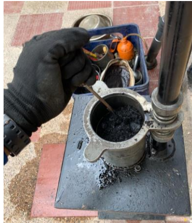
Figura 30. Apisonamiento de material en el interior del molde 25 veces.
