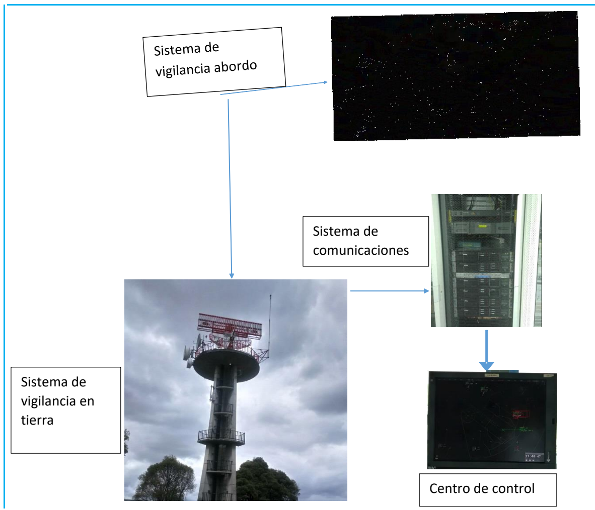
Figura 2. ESQUEMA GENERAL DE UN SISTEMA DE VIGILANCIA AERONÁUTICA
