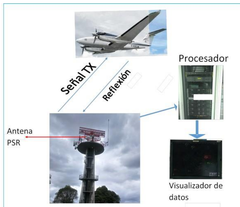
Figura 3. PRINCIPIO DE FUNCIONAMIENTO PSR Fuente: Fotos tomadas por el autor del proyecto
