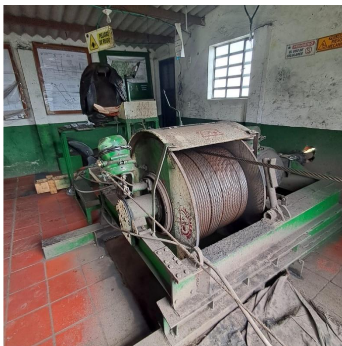
Ilustración 2. Sistema de transporte Malacate
