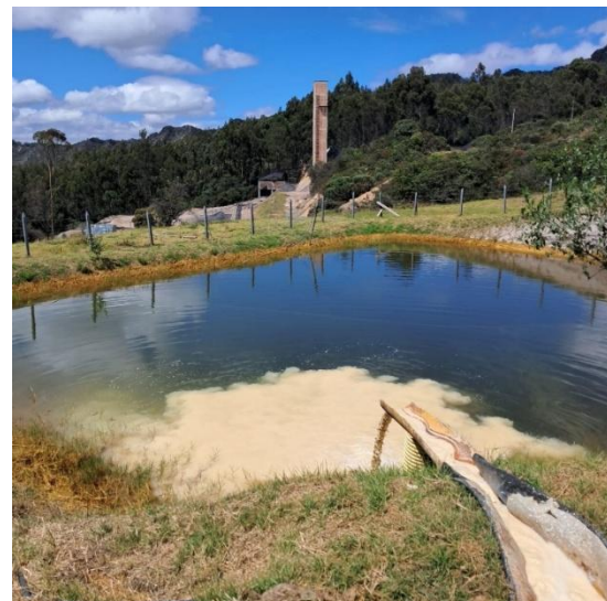
Ilustración 15. Dosificación diaria de cal en aguas residuales de la mina
