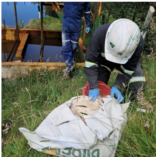
Ilustración 15. Dosificación diaria de cal en aguas residuales de la mina
