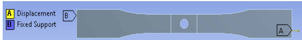
Figura 8. Condiciones de frontera para la simulación del modelo lineal y multilíneal. Fuente: Autor.
