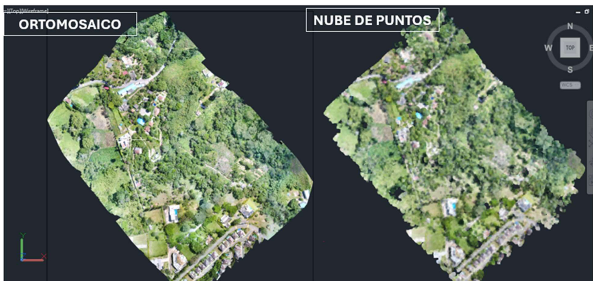
Figura 14. Enlace de Nube de puntos y Ortomosaico en Software AutoCAD
