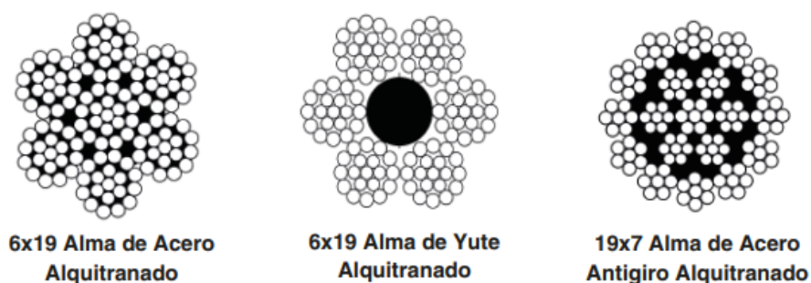
Imagen 6. Cables de acero alquitranado
