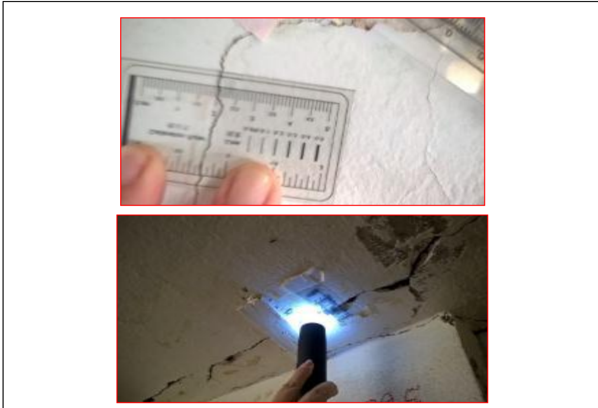
Foto 24. Utilización del microscopio digital inalámbrico en la medición de la abertura de las grietas y fisuras
