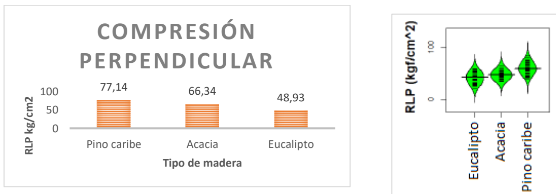
Figura 13.9 Compresión perpendicular en las tres especies maderables Fuente: Autores
