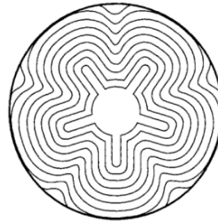
Figura 2. Diagrama de avance de contornos de superficies quemadas. Fuente: [9].
