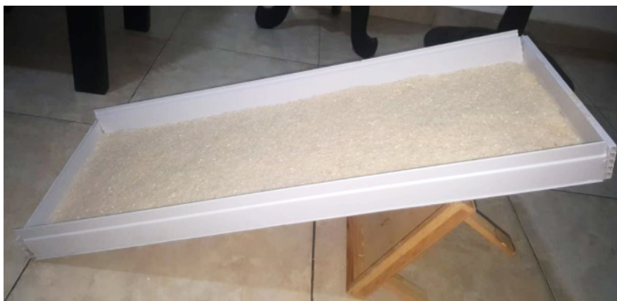
FIGURA 74. Pista de ensayo con el suelo granular simulado con arroz instalado e inclinada a la pendiente indicada
