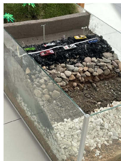
FIGURA 79. Modelo a escala, estructura de pavimento flexible
