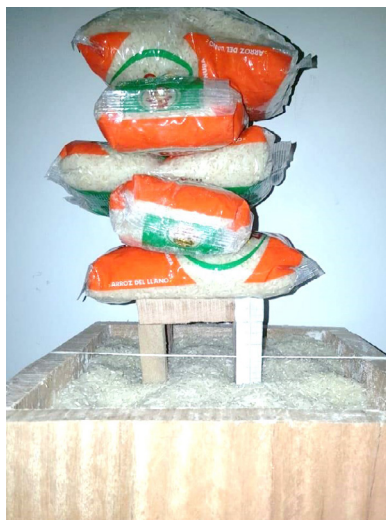
FIGURA 49. Proceso de carga y asentamiento de la estructura con columnas directamente apoyadas debido a la construcción de 5 pisos simulados con 5 libras simulados con 5 libras, sobre el suelo granular simulado con el arroz dentro de la caja
