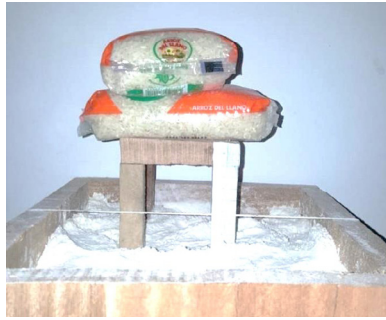
FIGURA 47. Detalle del montaje de la estructura simulada con columnas directamente apoyadas sobre el suelo fino, con dos unidades de carga (simula la construcción de un piso adicional)
