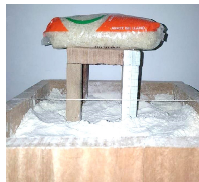
FIGURA 46. Detalle del montaje de la estructura simulada con columnas directamente apoyadas sobre el suelo fino, con una unidad de carga (simula la construcción de un piso adicional)
