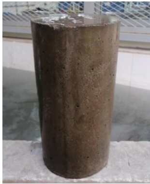
FIGURA 10. Cilindro de concreto
