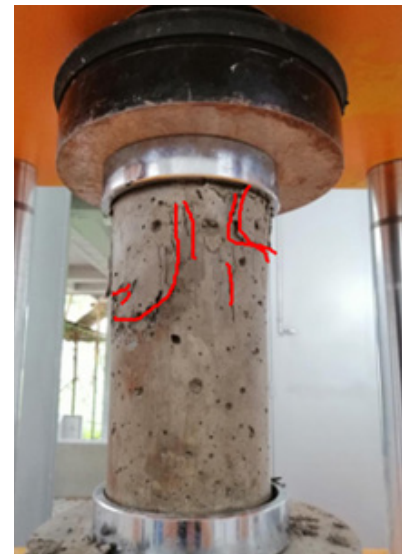
FIGURA 13. Fisuras resaltadas en cilindro de concreto
