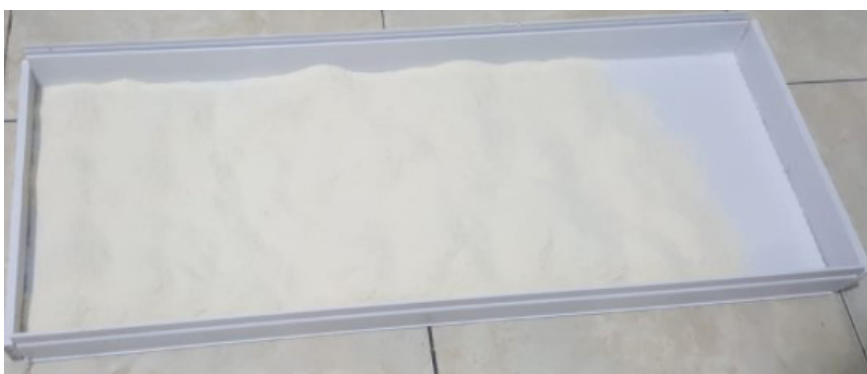
FIGURA 69. Pista de ensayo con harina, simulando suelo fino
