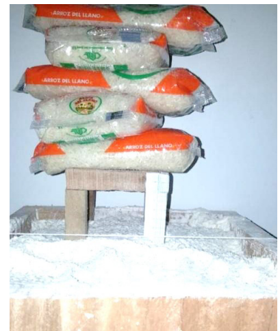
FIGURA 51. Proceso de carga y asentamiento de la estructura con columnas directamente apoyadas debido a la construcción de 5 pisos simulados con 5 libras sobre el suelo mixto, simulado con la mezcla de arroz y harina dentro de la caja
