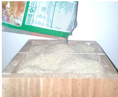
FIGURA 48. Detalle del llenado con arroz que simula el suelo granular
