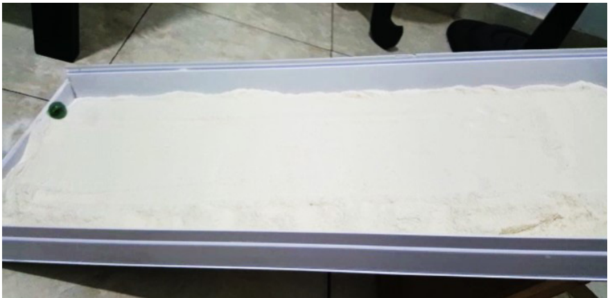
FIGURA 71. Pista de ensayo con harina simulando suelo fino, movimiento de la esfera de cristal
