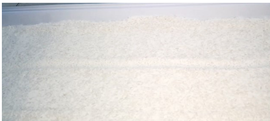
FIGURA 78. Detalle de la huella dejada por la esfera de cristal en el suelo mixto simulado con mezcla de arroz y harina instalado e inclinado a la pendiente indicada, sin ningún mejoramiento
