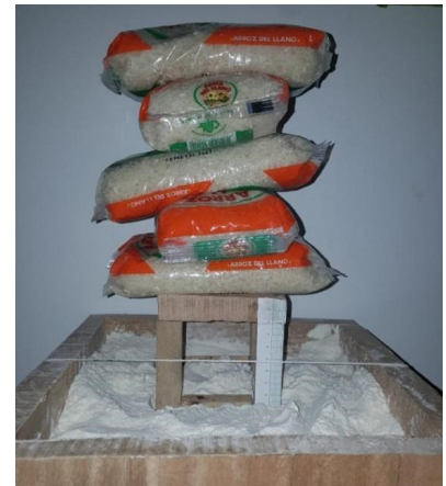
FIGURA 53. Proceso de carga y asentamiento de la estructura con columnas apoyadas sobre vigas de cimentación, debido a la construcción de 5 pisos simulados con 5 libras, sobre el suelo fino simulado con harina dentro de la caja
