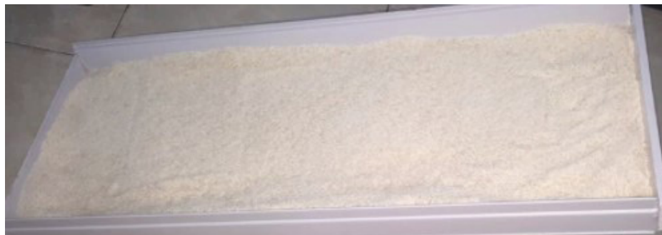
FIGURA 76. Pista de ensayo con el suelo mixto simulado con mezcla de arroz y harina con superficie de rodadura sin mejorar
