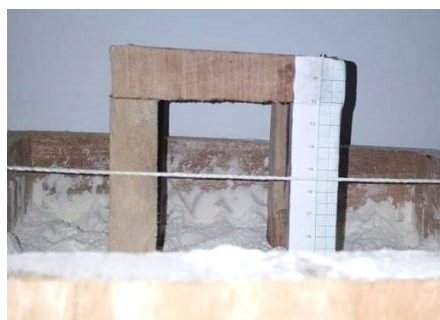
FIGURA 44. Detalle del papel milimetrado pegado en las patas de la mesa que simula la estructura, y del hilo que se coloca de lado a lado de la caja para tomar las lecturas de los asentamientos
