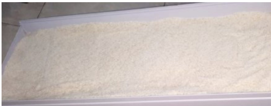
FIGURA 73. Pista de ensayo con cama de harina para instalar el suelo granular simulado con arroz
