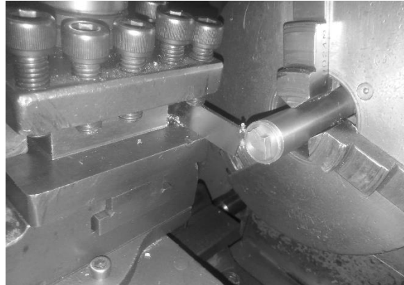
Figura 47. Tronzado de material en Bruto con contorno de mecanizado.
