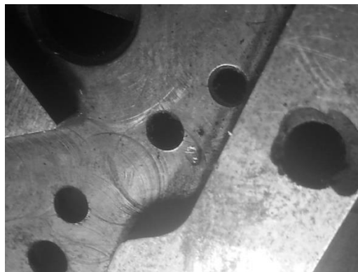
Figura 23. Marcas del proceso de fresado axial
