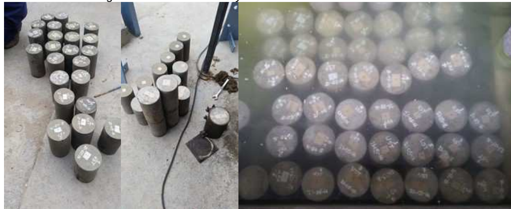
Figura 22. Desencofrado y Curado de Cilindros de Concreto.
