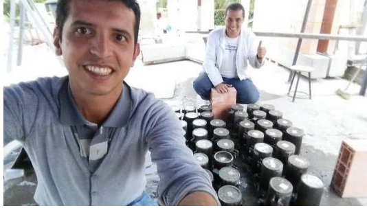
Figura 18. Cilindros de Concreto Fresco en sus Moldes.
