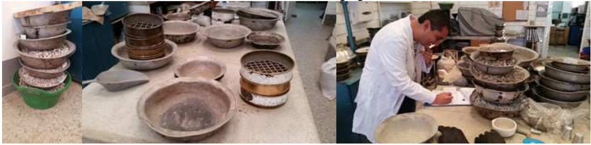
Figura 3. Gradación de Agregados.
