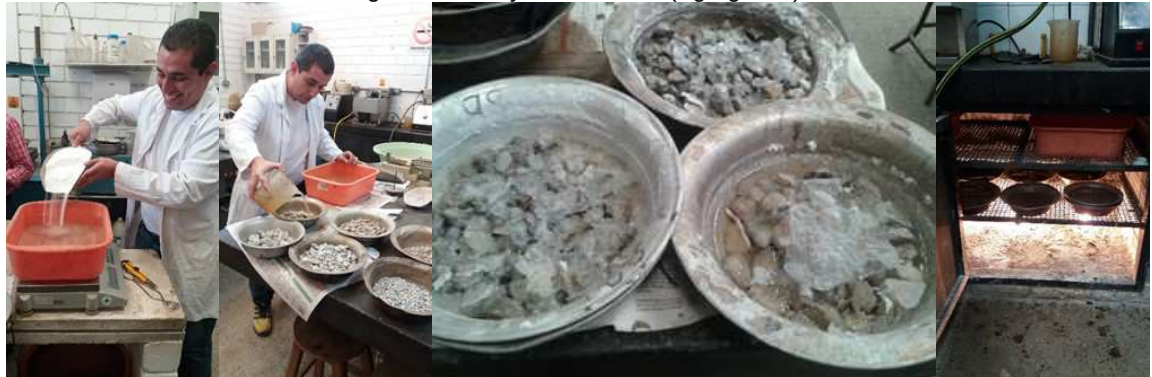
Figura 7. Ensayo de Sulfatos (Agregados).
