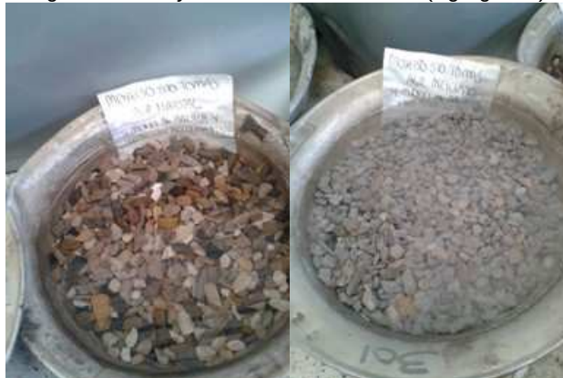
Figura 8. Ensayo de Terrones de Arcilla (Agregados).
