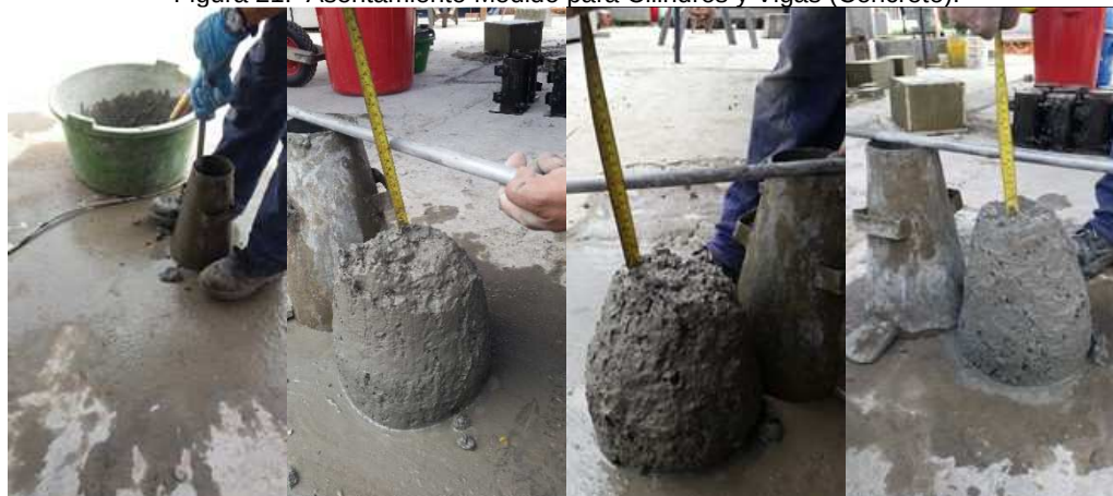
Figura 21. Asentamiento Medido para Cilindros y Vigas (Concreto).
