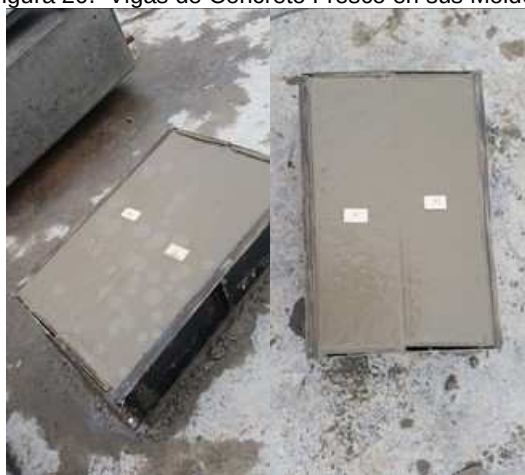
Figura 20. Vigas de Concreto Fresco en sus Moldes.
