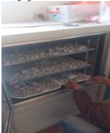
Figura 15. Ingreso de los Agregados Reciclados a la Cámara de Carbonatación.
