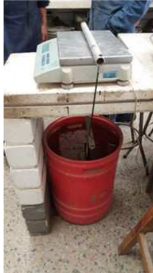
Figura 2. Ensayo de Densidad y Absorción (Agregados).
