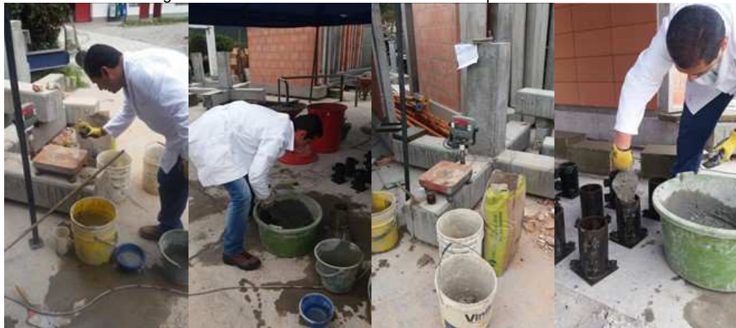
Figura 17. Elaboración Mezclas de Concreto para Cilindros.
