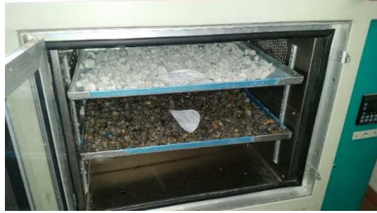
Figura 14. Ingreso de ARC a la Cámara de Carbonatación – Etapa 1.
