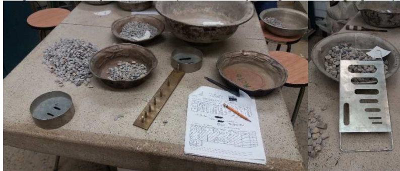
Figura 10. Ensayo Índice de Aplanamiento y Alargamiento (Agregados)
