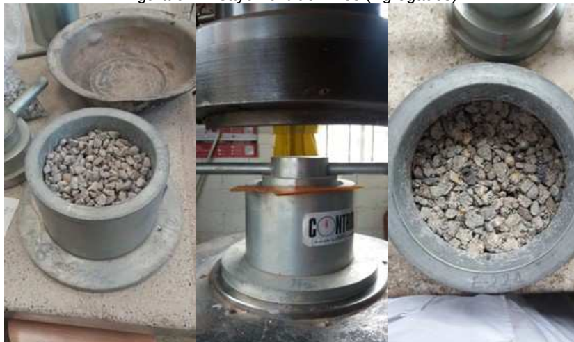
Figura 6. Ensayo 10% de Finos (Agregados).
