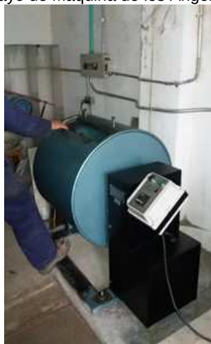
Figura 4. Ensayo de Máquina de los Ángeles (Agregados)
