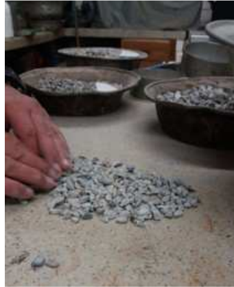
Figura 9. Ensayo de Partículas Fracturadas (Agregados)
