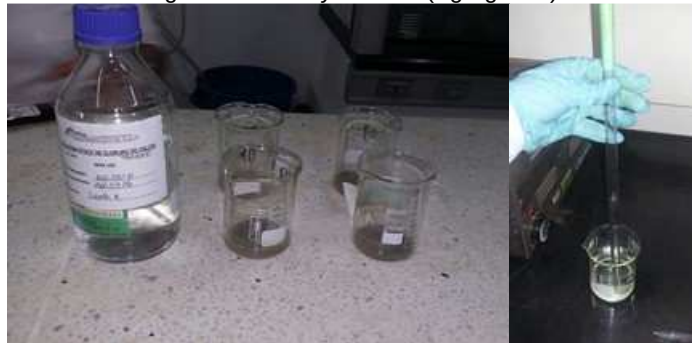
Figura 12. Ensayo de PH (Agregados).
