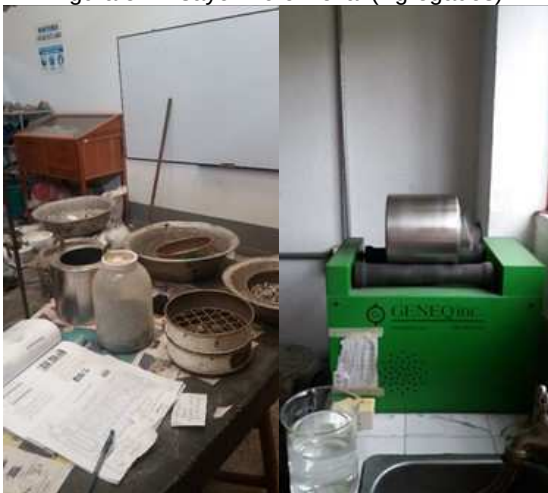
Figura 5. Ensayo Micro Deval (Agregados).
