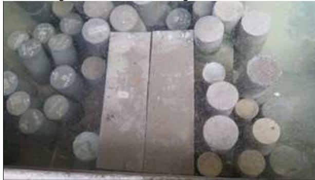
Figura 23. Curado de Vigas de Concreto.
