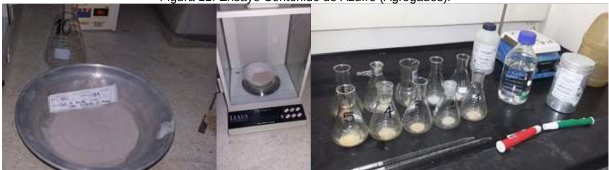
Figura 11. Ensayo Contenido de Azufre (Agregados).
