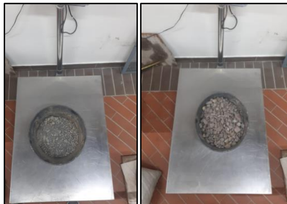
Figura 9.2 Preparación de agregado fino y agregado grueso para la mezcla Fuente: Autores
