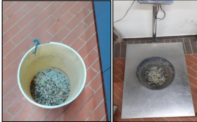
Figura 9.5 Preparación del vidrio molido para la mezcla Fuente: Autores
