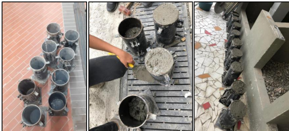
Figura 9.4 Camisas antes y después del llenado Fuente: Autores
