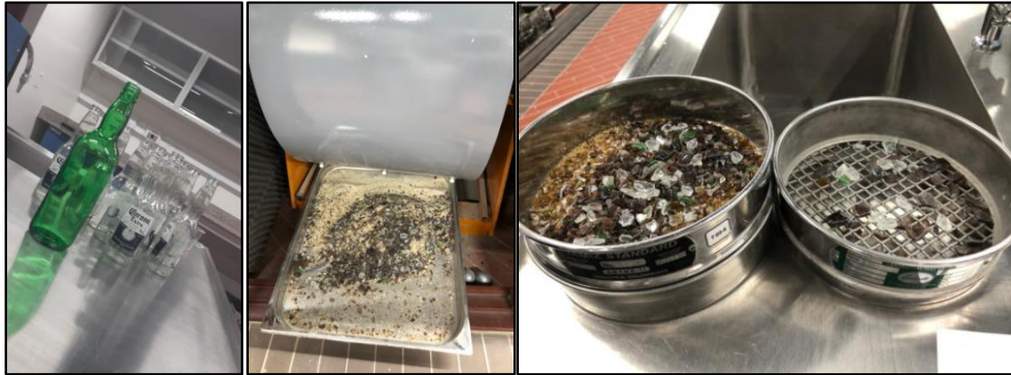
Figura 9.1 Limpieza y triturado de vidrio Fuente: Autores
